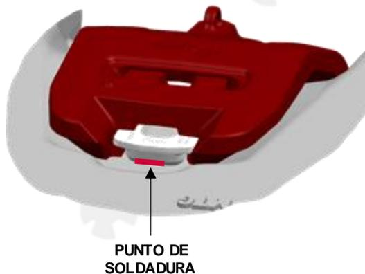
**5.6** Retirar el bloque mecánico y el protector. Verificar que tanto base como labio se encuentran todavía a una temperatura de entre 175°C y 200°C (347°F y 392°F) en un área de 100 mm (4”) alrededor de la zona a soldar y proceder con la soldadura de la base tal y como se describe en el apartado anterior (POSICIONAMIENTO DE LA BASE SOLDABLE MEDIANTE CALIBRE).
