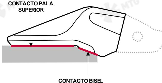
**4.1.3** Aplicar soldadura por puntos, de unos 25mm - 1 in. de longitud, en la ranura del adaptador destinada al cordón de soldadura. Esta soldadura por puntos debe aplicarse en ambos lados de la pala superior, justo entre el final de la pala y el borde del tacón del bisel.
