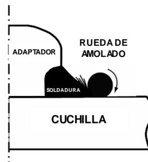
El amolado del radio en los cordones de las soldaduras se facilita utilizando abrasivos en forma de cono. Para el amolado final, el abrasivo no puede ser más grueso que 24 Grit.
