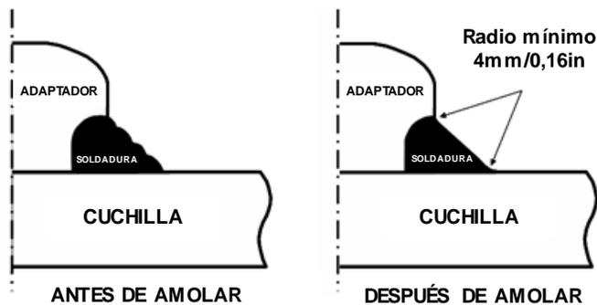
El amolado se realizará utilizando amoladoras eléctricas o neumáticas de alta velocidad con abrasivos de rectificado de no más de 50 mm a 2 pulgadas de diámetro. NO SE PERMITEN AMOLADORAS DE CABEZA ANGULAR O DE DISCO PARA ESTE TRABAJO.
