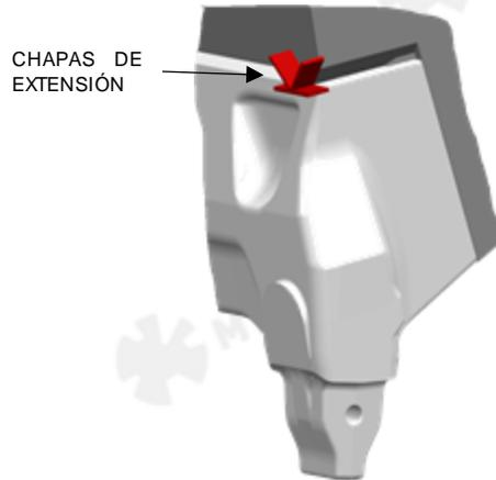
**4.6.16** Depositar cordón de raíz uniendo la parte interior trasera del labio con la interior del lateral del cazo/mandíbula en ambos lados. Descarnar el cordón de raíz por el exterior del cazo/mandíbula. Amolar todas las superficies descarnadas para eliminar toda la escoria e impurezas. Precalentar el lateral del labio y el lateral del cazo entre 175°C y 200°C (347°F y 392°F) .
