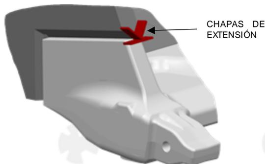
**4.6.8** Depositar cordones de raíz uniendo el interior del labio con el interior de la chapa del lateral del cazo/mandíbula en ambos lados. Descarnar el cordón de raíz por la parte exterior del cazo. Amolar todas las superficies descarnadas para eliminar toda la escoria e impurezas. Precalentar el lateral del labio y del cazo/mandíbula entre 175°C y 200°C (347°F y 392°F).
