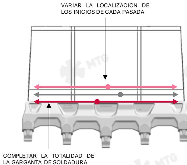
**4.6.6** Una vez se ha completado la soldadura de la parte trasera del labio al cazo/mandíbula, es el momento de realizar la unión de los laterales del labio al cazo/mandíbula.
