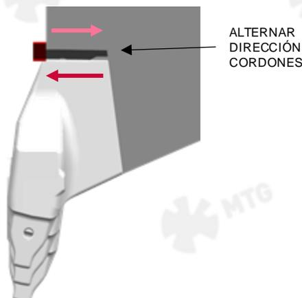
**4.6.19** Continuar con el proceso de soldadura hasta que los chaflanes de soldadura estén completamente llenos.
