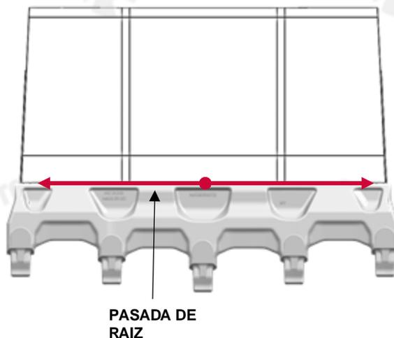
**4.6.2** Verificar nuevamente que la temperatura está todavía entre 175°C y 200°C (347°F y 392°F). Si la temperatura se encuentra por debajo de la especificada, precalentar de nuevo según especificaciones.
