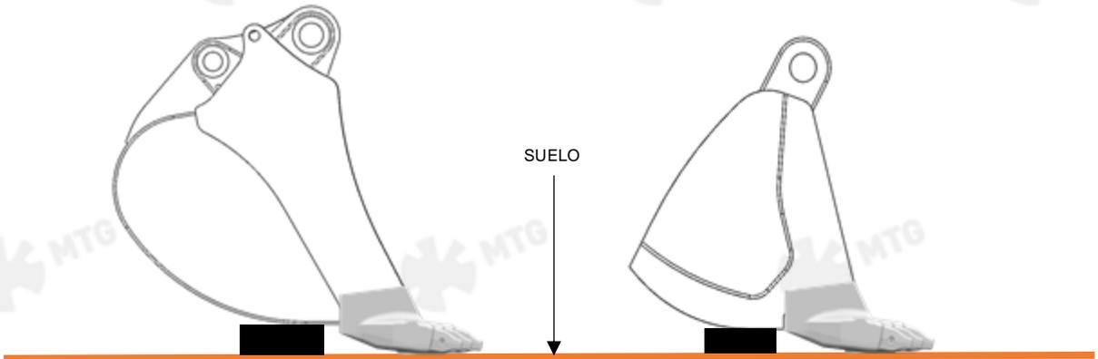
**4.6.7** Antes de proceder, verificar que la temperatura de la zona a soldar esta todavía entre 175°C y 200°C (347°F y 392°F) en un radio de 100mm (4") alrededor de la garganta de soldadura. Si la temperatura se encuentra por debajo de la especificada, precalentar de nuevo según especificaciones.
