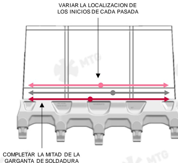
**4.6.4** Soldar la parte trasera del labio al cazo/mandíbula por la parte interior hasta completar la totalidad de la garganta de soldadura. Las pasadas de soldadura deben empezar en el centro del labio, variando la localización de cada inicio y acabar en los laterales sin continuar hacia ellos.
