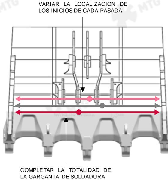
**4.6.5** Rellenar la mitad restante de la garganta de soldadura por la parte exterior del cazo/mandíbula. De igual manera que anteriormente, las pasadas de soldadura deben empezar en el centro del labio, variando la localización de cada inicio y acabar en los laterales sin continuar hacia ellos.
