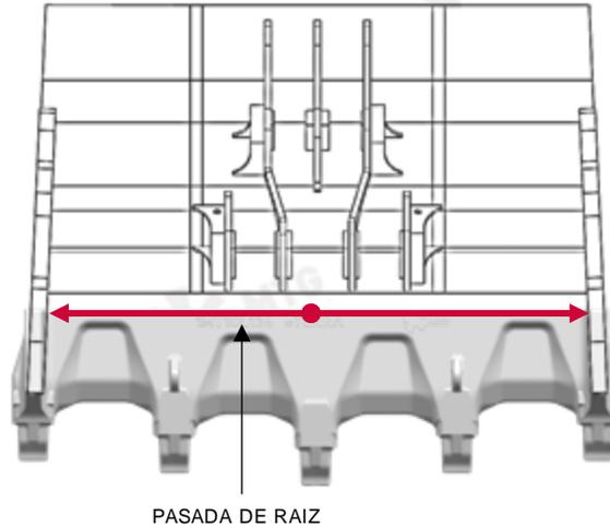
**4.6.3** Soldar la parte trasera del labio al cazo/mandíbula por la parte exterior hasta completar la mitad de la garganta de soldadura. Las pasadas de soldadura deben empezar en el centro del labio, variando la localización de cada inicio y acabar en los laterales sin continuar hacia ellos.
