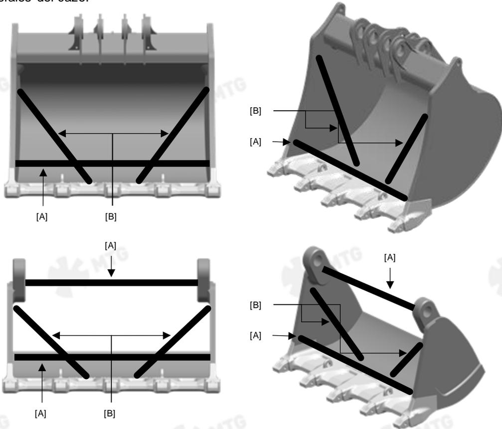
**4.1.2** Marcar líneas de corte basadas en la soldadura del labio a sustituir y comparar dimensiones con el nuevo labio. Para cazos de retroexcavadora, estas líneas de corte, deberán ser corregidas en el caso que el radio del diente más adelantado, sea superior al existente. Proceder con el corte mediante soplete y retirar el labio usado.
