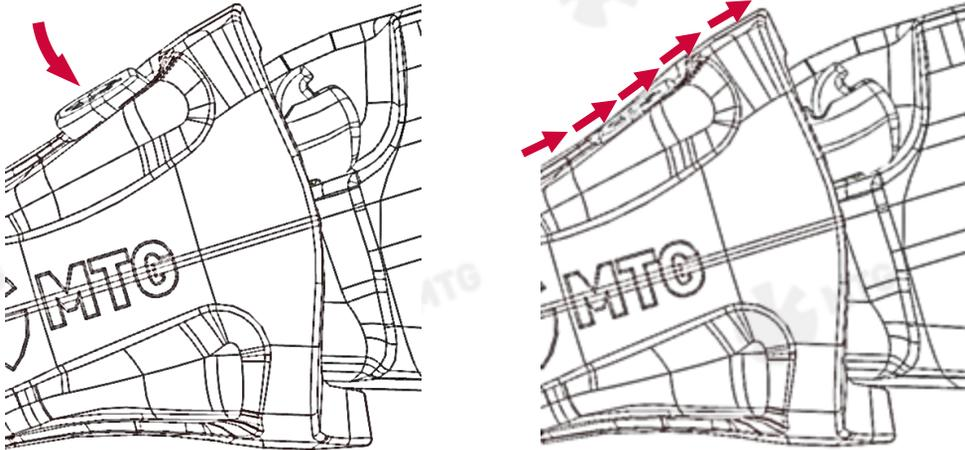
**3.2** Presionar la lengüeta de retención con la ayuda de un destornillador o similar apoyándose en la ranura de la misma [A] hasta que quede completamente comprimida en el interior del cuerpo del pasador [B].
