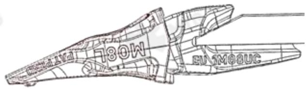
**2.2** Introducir el pasador. El logotipo de MTG debe ser visible. Empujar el pasador hacia dentro comprimiendo la pestaña de retención hasta que este llega al final del recorrido dónde la pestaña de retención se descomprima de nuevo.
